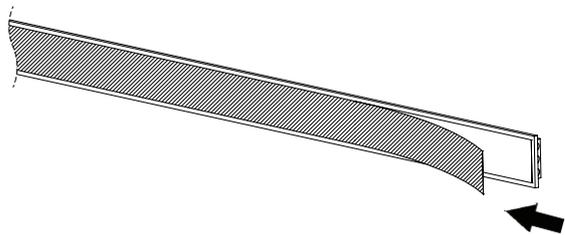
Limpe bem a superfície onde a Fita LED será aplicada, remova o filme da dupla-face e fixe a Fita LED no local desejado aplicando leve pressão.
