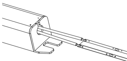
Conecte o fio positivo (+) e o fio negativo (-) da Fita LED aos respectivos terminais da fonte de alimentação. **A fonte de alimentação é vendida separadamente.**
