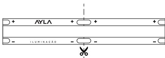
Se necessário, corte a fita apenas nos locais indicados. **Teste antes de cortar! O corte deste item invalida a garantia.**
