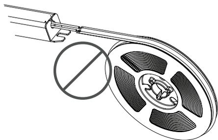
Antes de iniciar a instalação, verifique a integridade do produto e teste o funcionamento da Fita LED. Não ligue a Fita LED enrolada, para evitar o sobreaquecimento e danos aos componentes.
