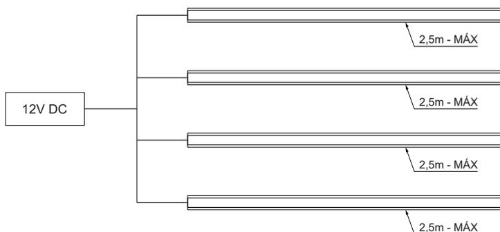
\* Devido a perda de tensão do circuito elétrico de baixa tensão, é necessário fazer a realimentação a cada 2,5m de fita, utilize este esquema de ligação para fitas de LED 12V com potência igual ou superior à 6W/m, para modelos de LED SMD e COB, afim de manter a uniformidade da iluminação.
